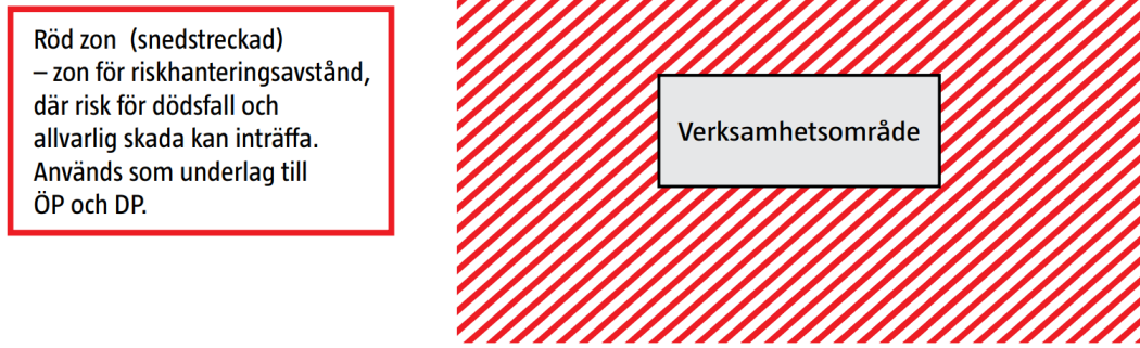
Figur 4. Illustration som visar schabloniserade riskhanteringsavstånd som angetts som "större än", vilket illustreras med en snedstreckad röd zon från fastighetsgräns. Det gäller för explosiva varor, giftiga gaser, giftiga ämnen och frätande ämnen. I dessa fall bör risken för dödsfall och skada beaktas till angivet riskhanteringsavstånd. För dessa planeringsfall är det särskilt relevant att ta fram ett verksamhetsanpassat riskhanteringsavstånd [4].
