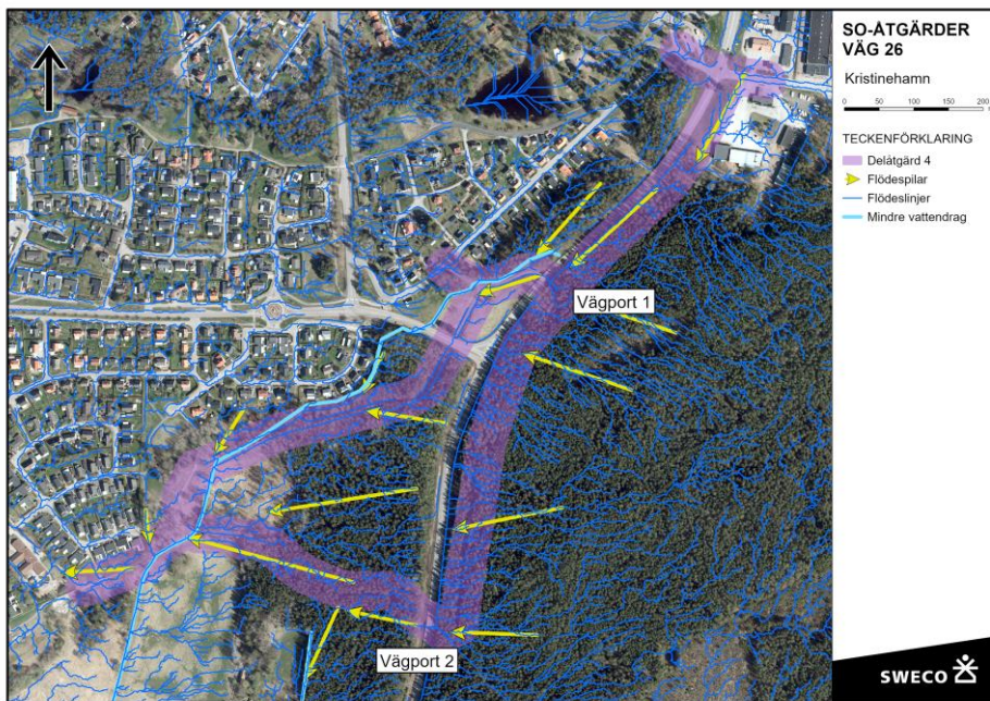
Figur 3-25. Flödeslinjer in och ut från Delåtgärd 4 (Data: Scalgo Live. Ortofoto: Lantmäteriet, geodatasamverkan).
