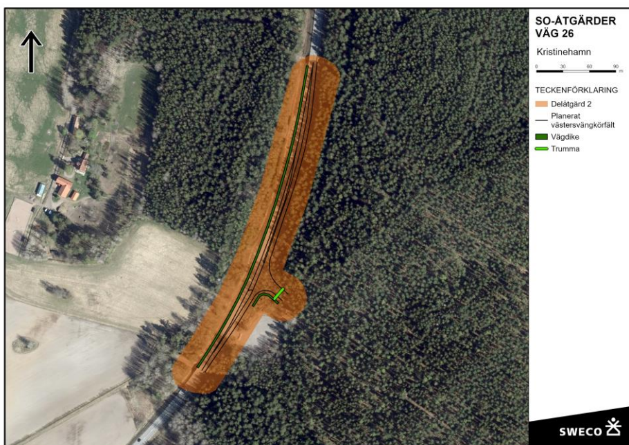
Figur 6-2. Föreslagen dagvattenhantering med presenterade ytanspråk inom Delåtgård 2 (Ortofoto: Lantmäteriet, geodatasamverkan. Cirkulationsplats och GC-väg: ritning 02, Sweco, 2023c).
