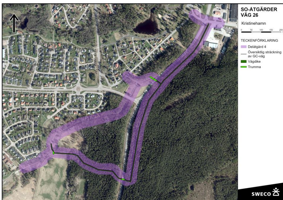
Figur 6-3. Föreslagen dagvattenhantering med presenterade ytanspråk inom Delåtgärd 4 (Ortofoto: Lantmäteriet, geodatasamverkan).
