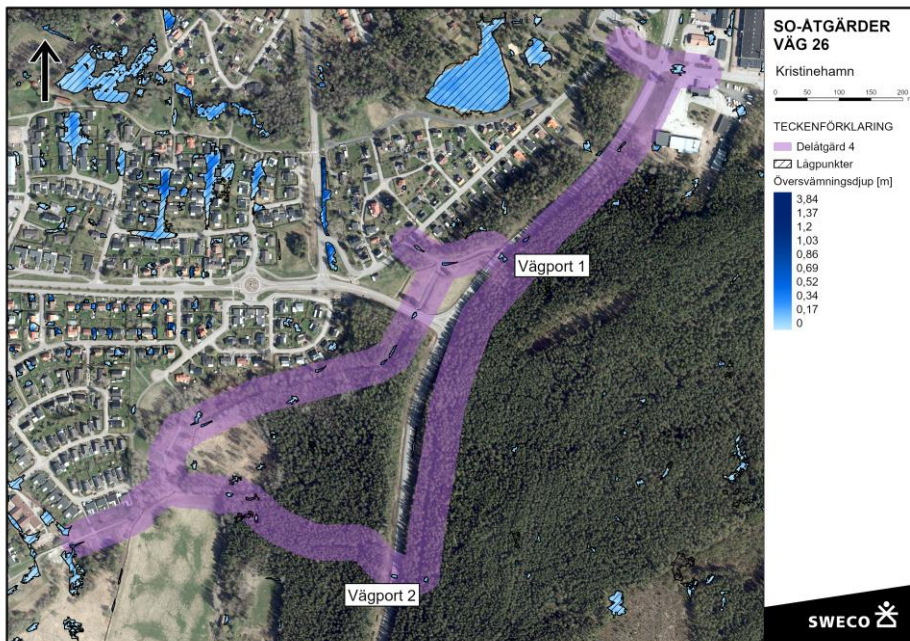
Figur 3-16. Befintliga lågpunkter där det finns risk för översvämning inom Delåtgärd 4 (Data: Scalgo Live. Ortofoto: Lantmäteriet, geodatasamverkan).
