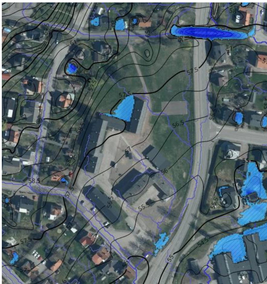
Karta från Scalgo som visar de huvudsakliga flödesvägarna och vattenansamlingarna vid ett skyfall med 58 mm regn.
