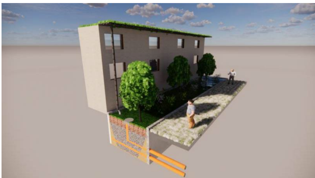
Bild: Regnbädd med underliggande filtermaterial och dräneringsledningar (Illustration: Sweco.) Dagvattenutredning A9, Harberget Kristinehamn Fortifikationsverket, Sweco 2023-08-29.
