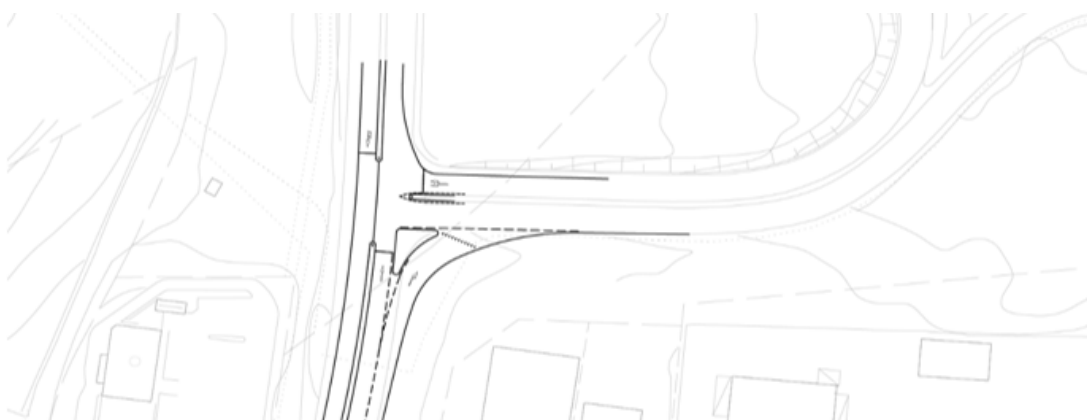
Bild: Utformningsförslag på Kvarnmotets trafikplats för att hantera ett extra körfält söderifrån. Inledande trafikutredning Harberget, Förslag till väganlutningar till det nya regementet A9 på Harberget i Kristinehamns kommun, Sweco 2024-08-12.
