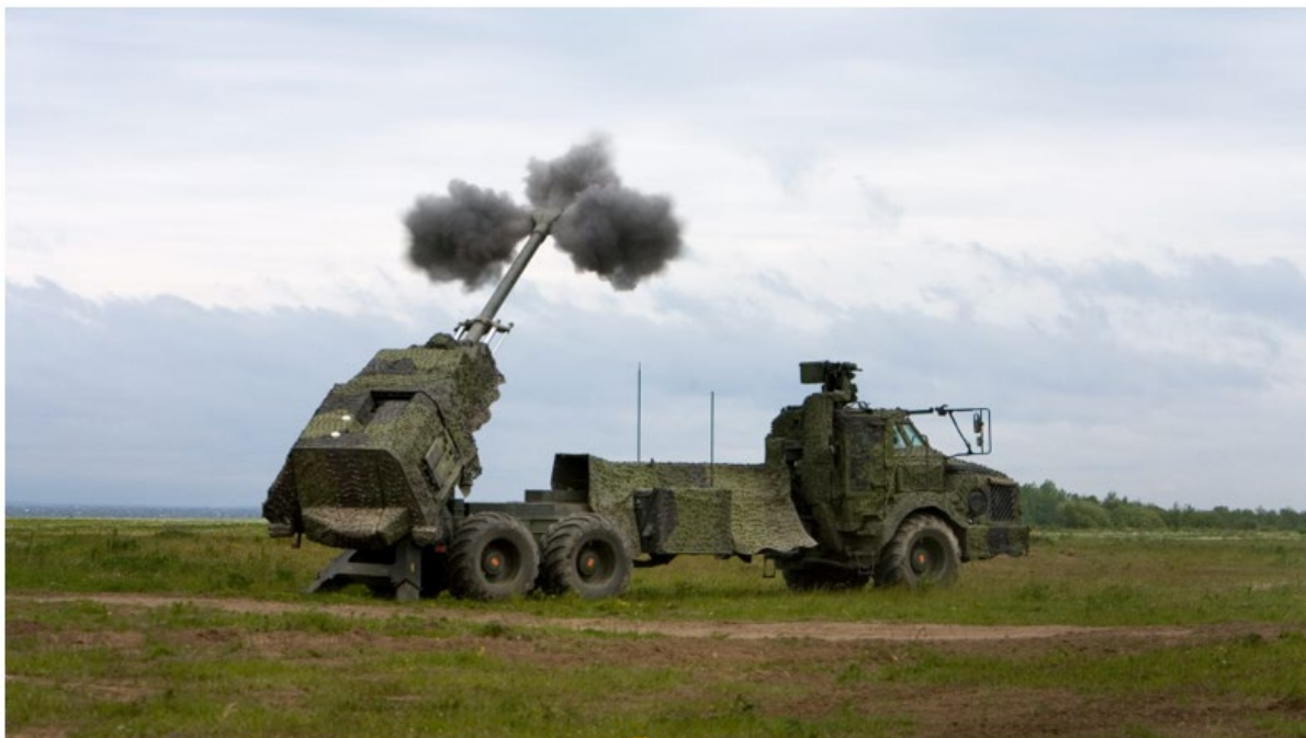
Bild: Fordonstypen Archer, en variant av artilleripjäsen Haubits 77B, där pjäsens överlavett har monterats på en terrängvagn som dras av en tungdragare. Inledande trafikutredning Harberget, Förslag till väganslutningar till det nya regementet A9 på Harberget i Kristinehamns kommun, Sweco 2024-08-12.
