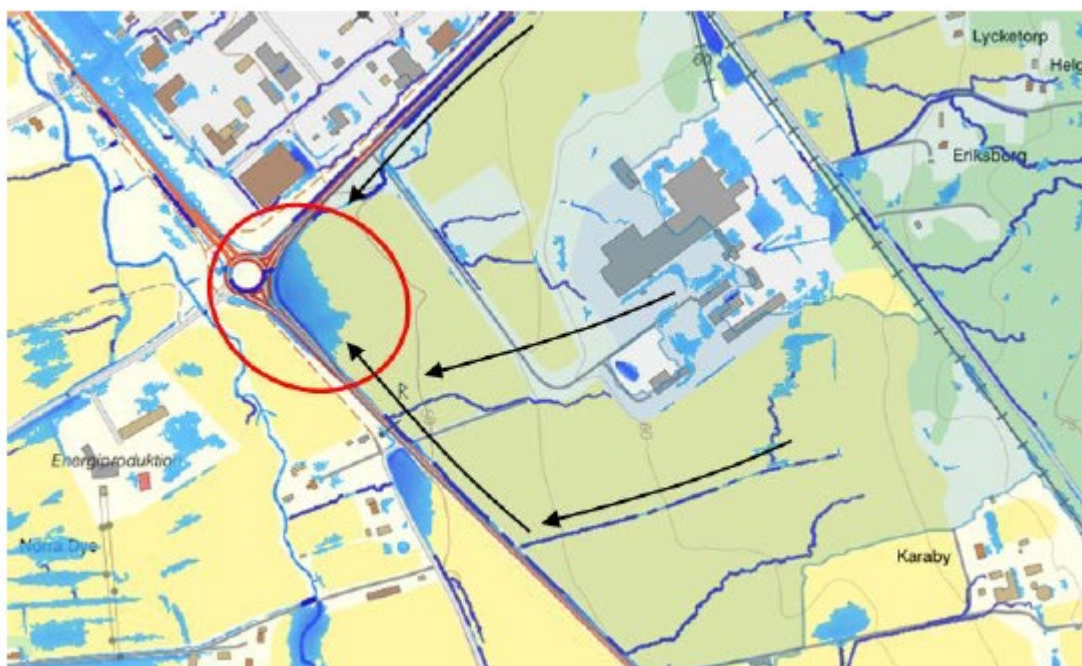
Bild: Riskområde nedströms utredningsområdet i avrinningsområde 5. Vattnet avrinner till en lågpunkt vid cirkulationsplatsen vid väg 26. Skyfallsutredning Regemente A9 Kristinehamn Sweco 2024-06-25.
