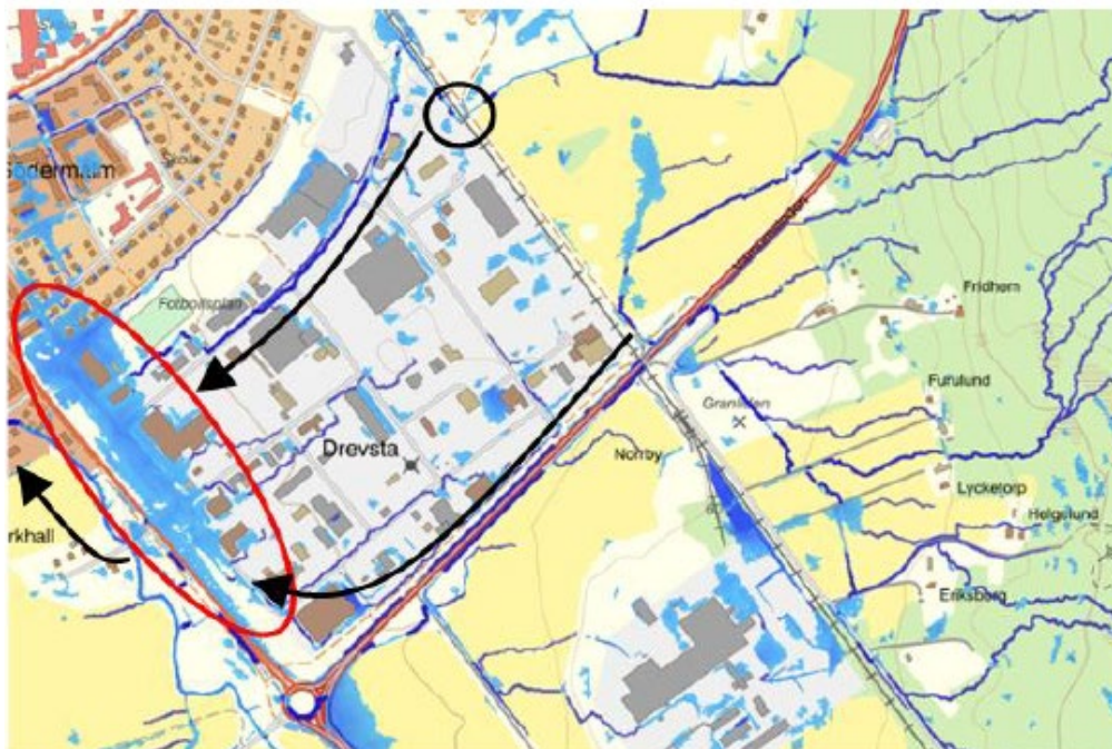
Bild: Lågpunkter utanför planområdet som får stående vatten vid skyfall idag. Röd markering visar lågpunkter och pilarna avrinningsriktning. Svart markering är kuperterat dike. Skyfallsutredning Regemente A9 Kristinehamn Sweco 2024-06-25.
