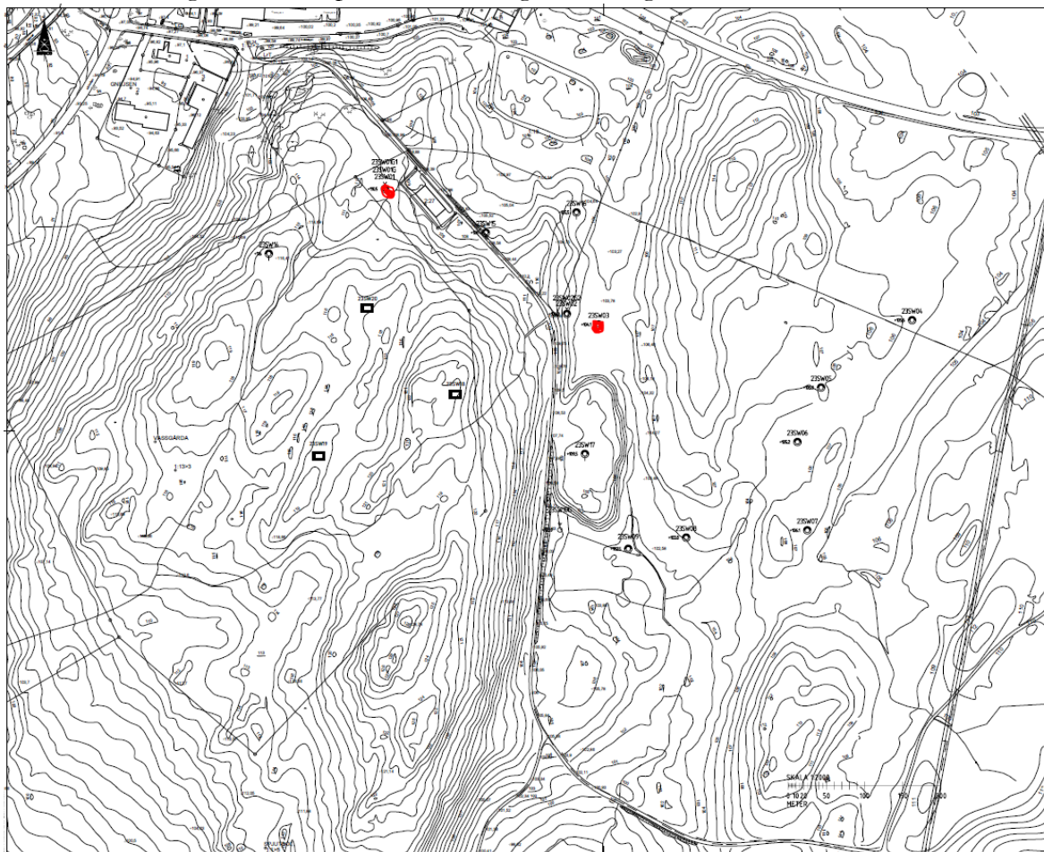
Bild: Röd markering visar de två provpunkterna, 23SW01 och 23SW03, där halter över MKM har påvisats. Resultatrapport översiktlig miljöteknisk markundersökning, Harberget Kristinehamn, Sweco, 2023-06-21
